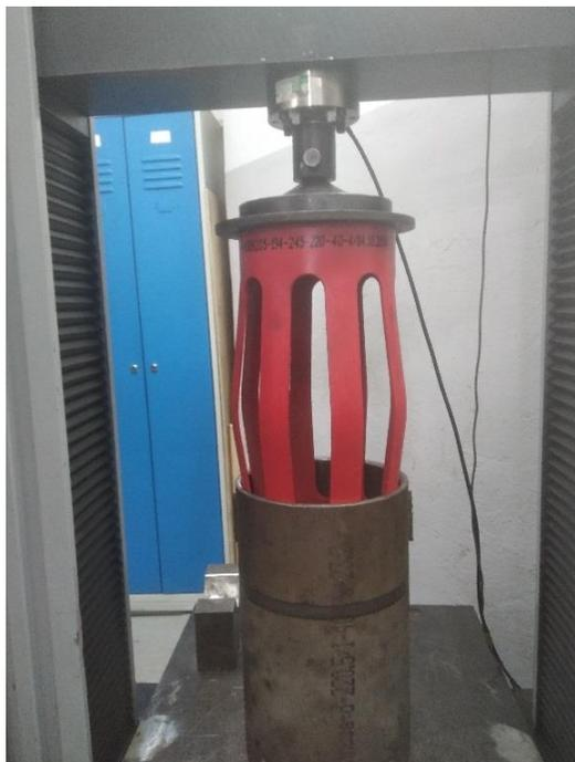
**Установка для испытания на определение величины радиального центрирующего усилия, создаваемого центратором**
